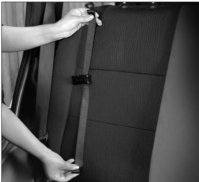
1. Das freie Ende des Gurtes unter dem unteren Rand der Rückenlehne durchführen.
